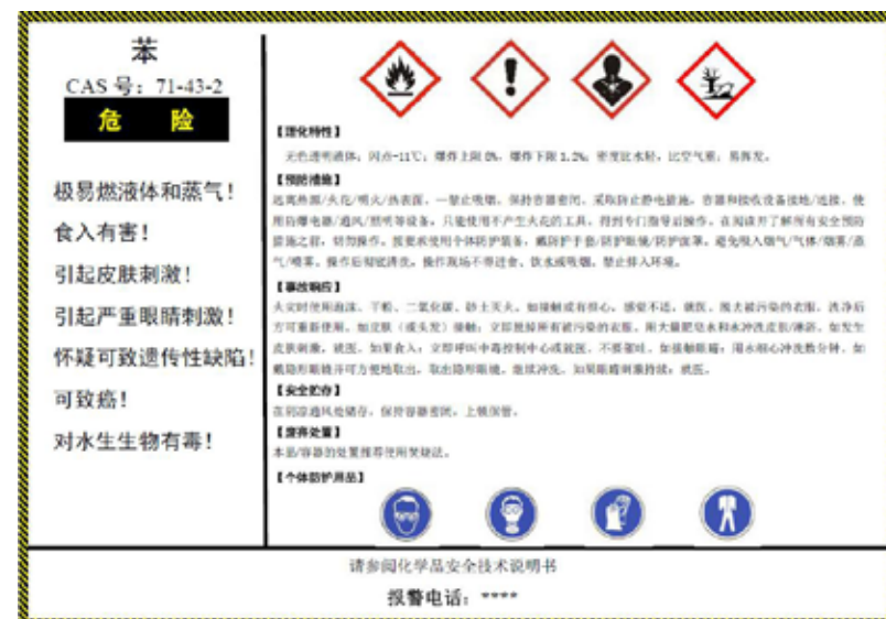
图 2-16 化学品作业场所安全警示标识样例
