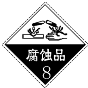
图 2-12 腐蚀性警示标识
