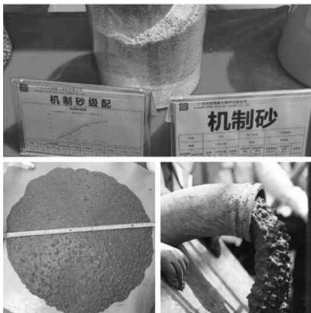
C130 混凝土使用的机制砂、实验室试配的 C130 混凝土拌合物扩展度(左下)以及浇筑现场 C130 混凝土出泵管状态(右下)
