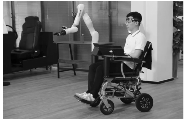
团队研发的轮椅脑机协同控制系统
