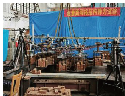
网格结构堆载静力试验
