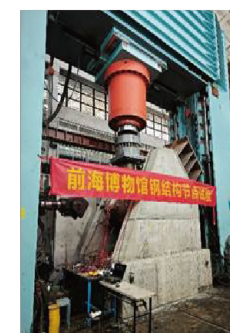
前海博物馆钢结构节点试验
