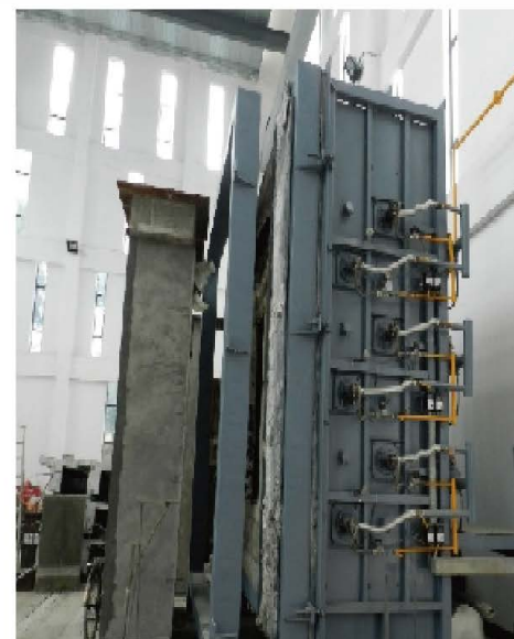
墙式构件耐火实验炉
