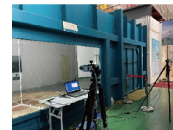
输电线塔风致位移测量
