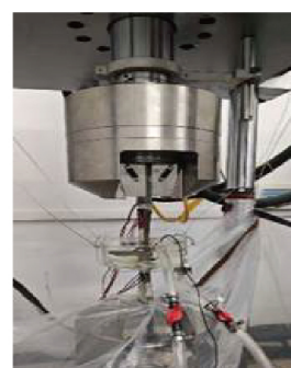
焊接节点腐蚀疲劳试验
