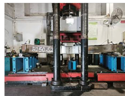
高强钢梁四点弯曲试验
