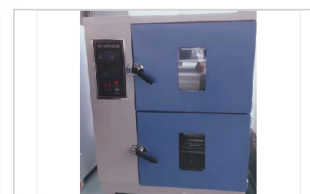
混凝土碳化箱
