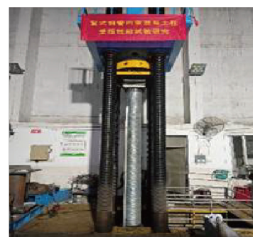
钢管混凝土柱静压试验
