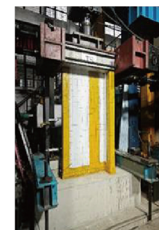
装配式剪力墙试验
