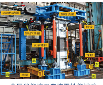
金属消能柱双向抗震性能试验
