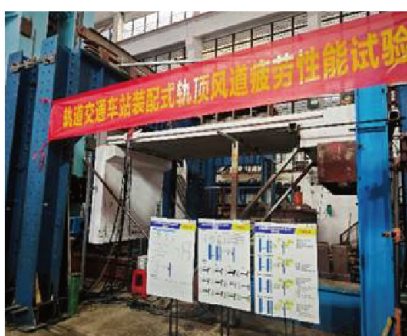
轨道交通车站轨顶风道疲劳试验
