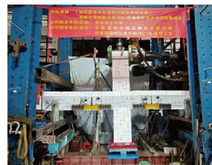
装配式RC框架梁柱节点试验
