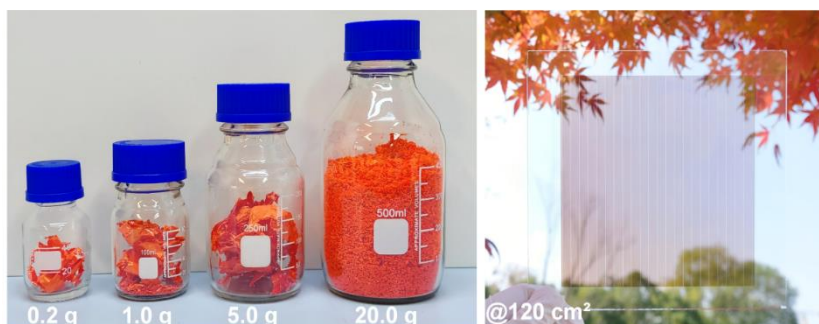
图 1 可放大合成的光伏聚合物及其大面积半透明器件
