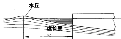
图 2-19 方尾船的虚长度
