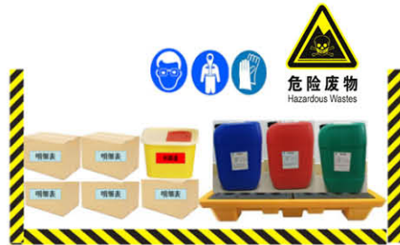
图 7-3 危险化学废物存储规范示例
