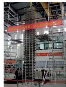
钢管混凝土柱排架
