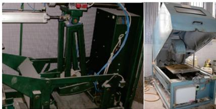
芬兰SRC振动轮碾成型设备与高精度切割机
