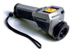
FLIR ThermoCAM™ E30红外成像仪
